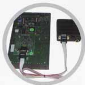
Módulo GSM Módem GSM conectado a la unidad de mando y de manejo central de la caldera
