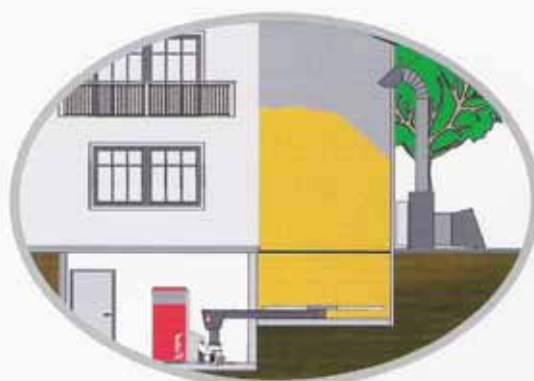
Llenado del depósito con ventilador.
