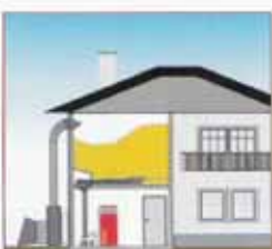
Extracción mediante tubo de bajada
