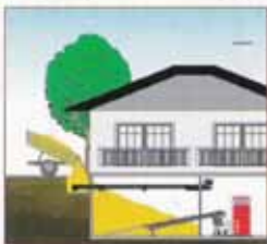
Extracción del cuarto con sinfín ascendente y extracción del combustible en el techo para el llenado óptimo del depósito.
