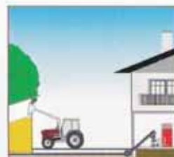
Longitud del canal del sinfín de más de 15 metros posible (varios elementos)
