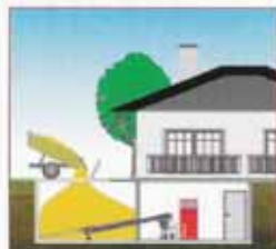
Extracción del cuarto con sinfín ascendente
